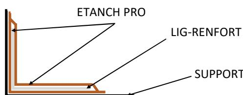
*Schéma de la mise en place de LIG-RENFORT marouflé entre 2 couches de ETANCH PRO de  $500\text{ g/m}^2$  environ chacune.*
